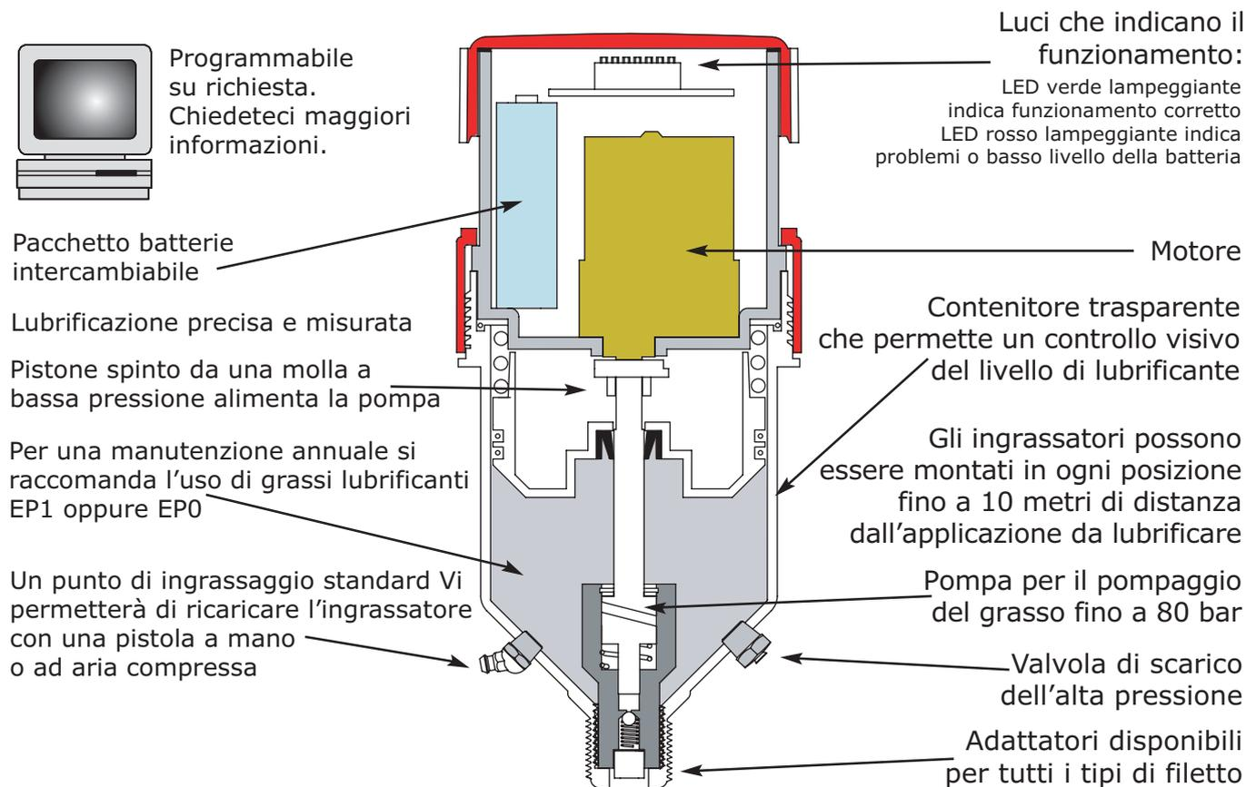
Temperatura di funzionamento -10°C to +76°C
